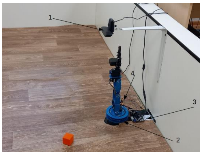
Рис. 11. Общий вид системы манипулятор - камера. 1 — USB -камера, 2 — манипулятор, 3 — плата расширения для питания сервоприводов, 4 - плата Arduino Nano для связи с ПК
