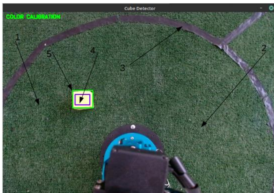
Рис. 15. Окно программы в режиме калибровки: 1,2 – Рабочая область манипулятора, 3 – Граница рабочей области манипулятора. 4 – Ручная калибровка по цвету объекта с помощью «мышки» (фиолетовый прямоугольник), 5 – Выполнена детекция объекта, поэтому он выделен зелёным прямоугольником
