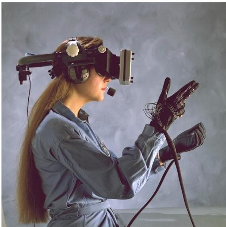
Рис. 3. Оператор в шлеме и перчатках виртуальной реальности
