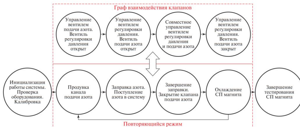
Рис. 5. Технологический процесс заправки азотом
