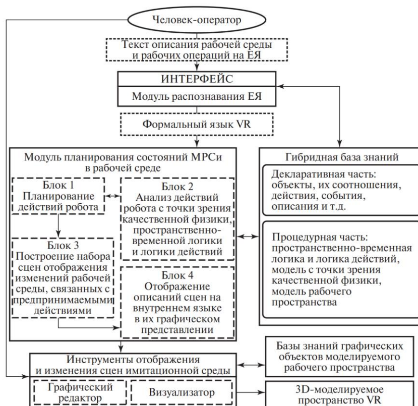
Рис. 5. Структура имитационной системы моделирования поведения и состояния «искусственной жизни» робота
