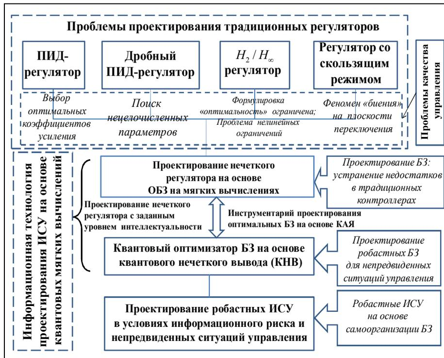
Рис. 19. Структура реализации информационной технологии проектирования робастных интеллектуальных регуляторов
