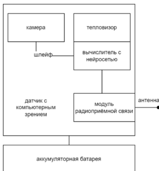
Рис. 1. Схема предлагаемого решения
