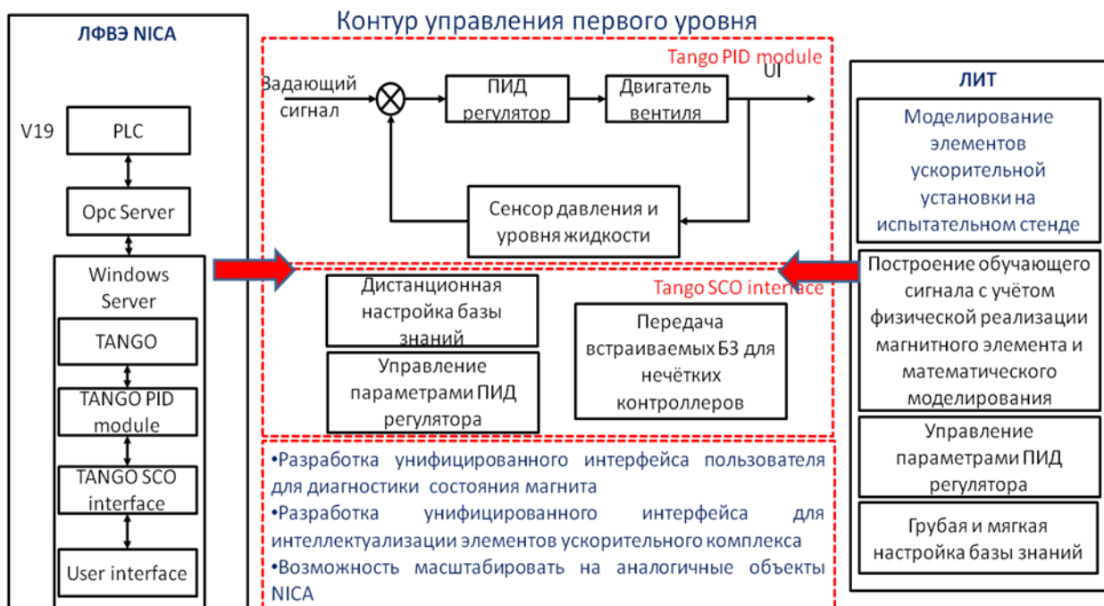
Рис. 4. Контур управления первого уровня, на основе встраиваемого программного ПИД-регулятора
