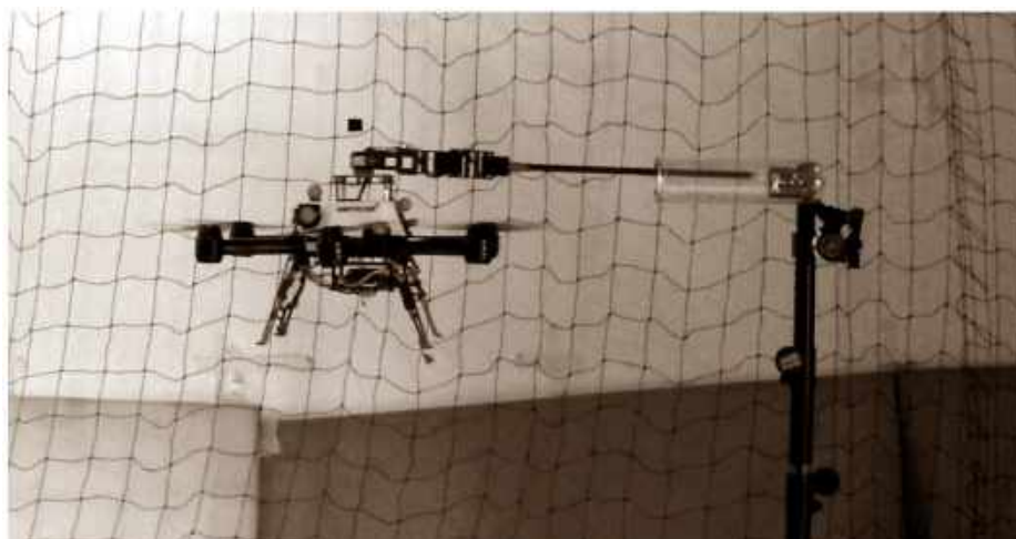
Рис. 11. БПЛА, оснащенный манипулятором с тремя DoF, выполняет задачу по установке штифта в отверстие [28]
