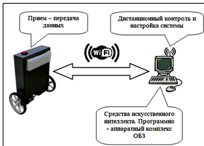
Рис. 12. Схема соединения настраиваемого устройства и ОБЗ
