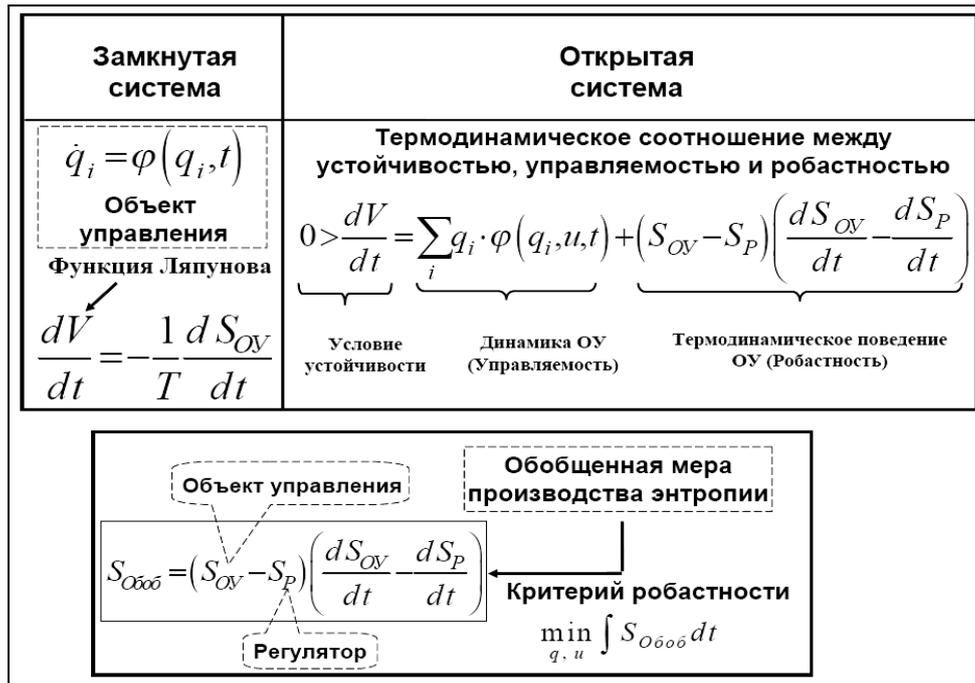
Рис. 1. Термодинамический критерий качества робастного управления
