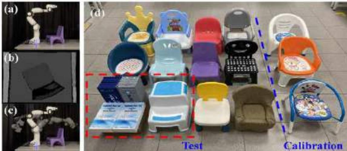
Рис. 12. Данные. (b) показывает захваченное изображение глубины, когда робот находится в позе захвата, показанной на (a). (c) показаны три позы захвата 3D-сканирования. (d) показывает все стулья в наборе данных. Среди стульев в испытательном наборе два из них, указанные в красном поле, не являются типичными стульями, но могут позволить себе сидячую возможность. Один из них - табурет; другой импровизирован, собирая книги и коробки
