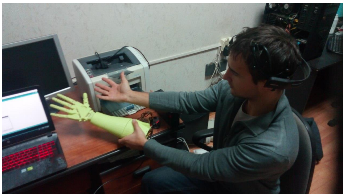
Рис. 14. Проведение эксперимента (выполнение команды «Расжатие»)
