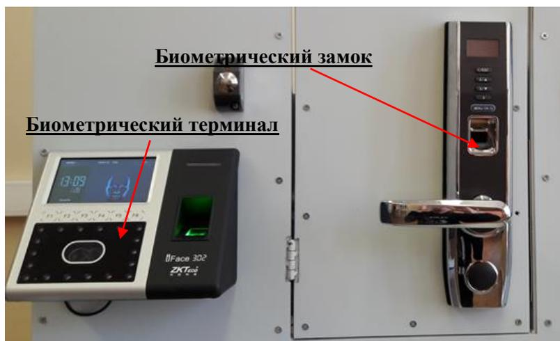
Рис. 1. Стенд с биометрическими СКУД
