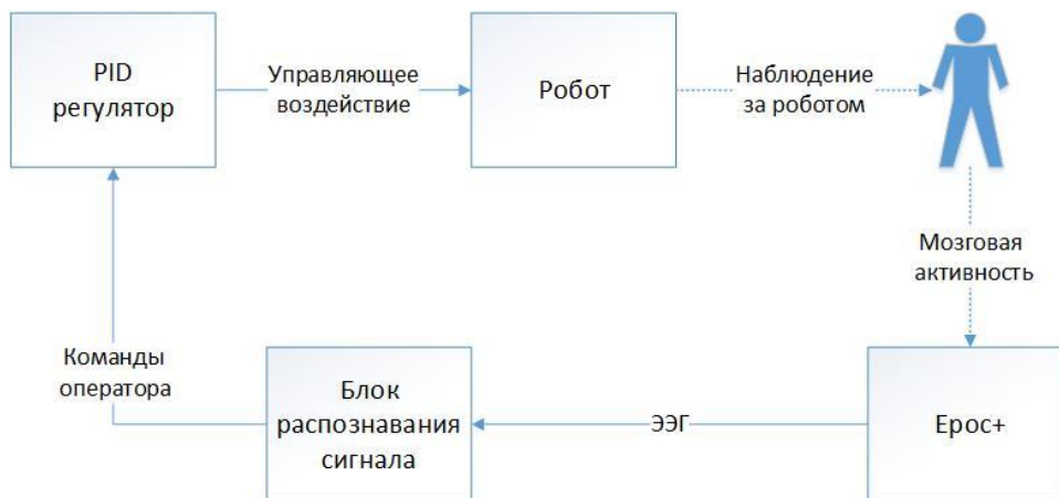
Рис. 11. Структурная схема программы с ПИД регулятором
