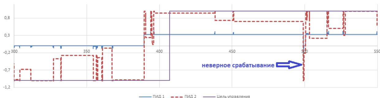
Рис. 23. Управляющие воздействия, вырабатываемые ПИД регуляторами при движении вперед
