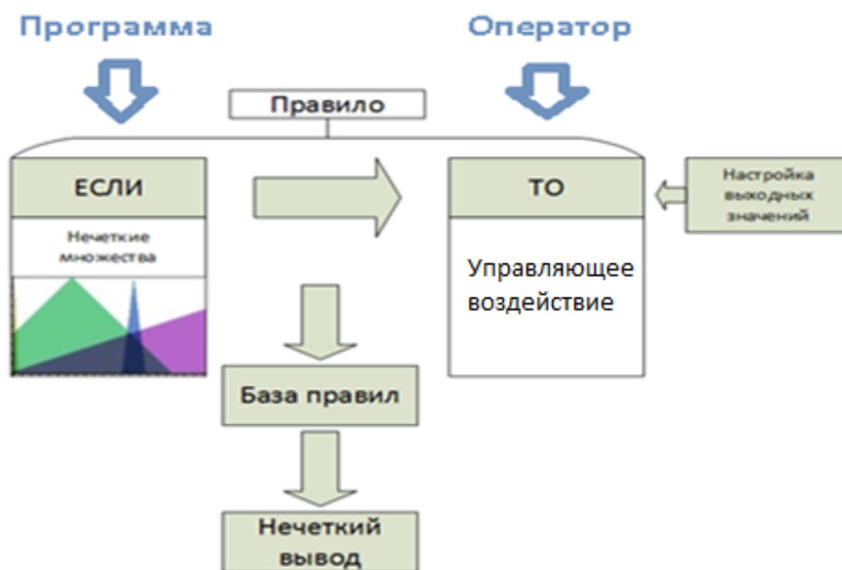
Рис. 17. Структурная схема формирования правила в базе знаний
