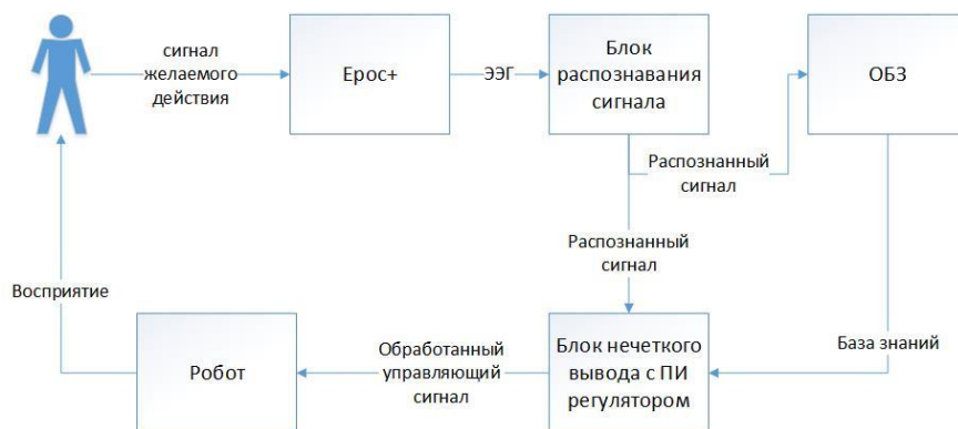
Рис. 10. Структурная схема программы с блоком нечеткого вывода и базой знаний
