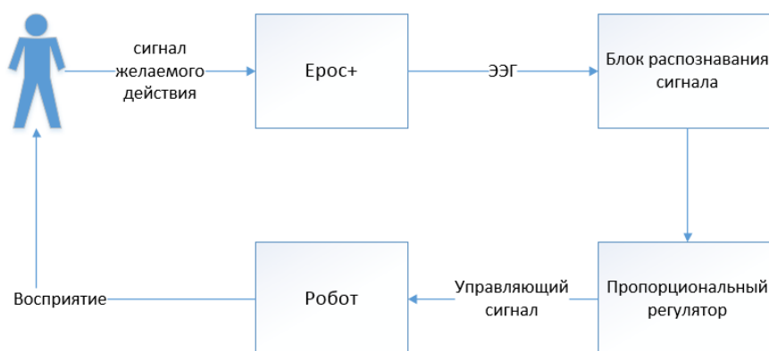
Рис. 9. Структурная схема пропорционального регулятора в контуре когнитивного управления
