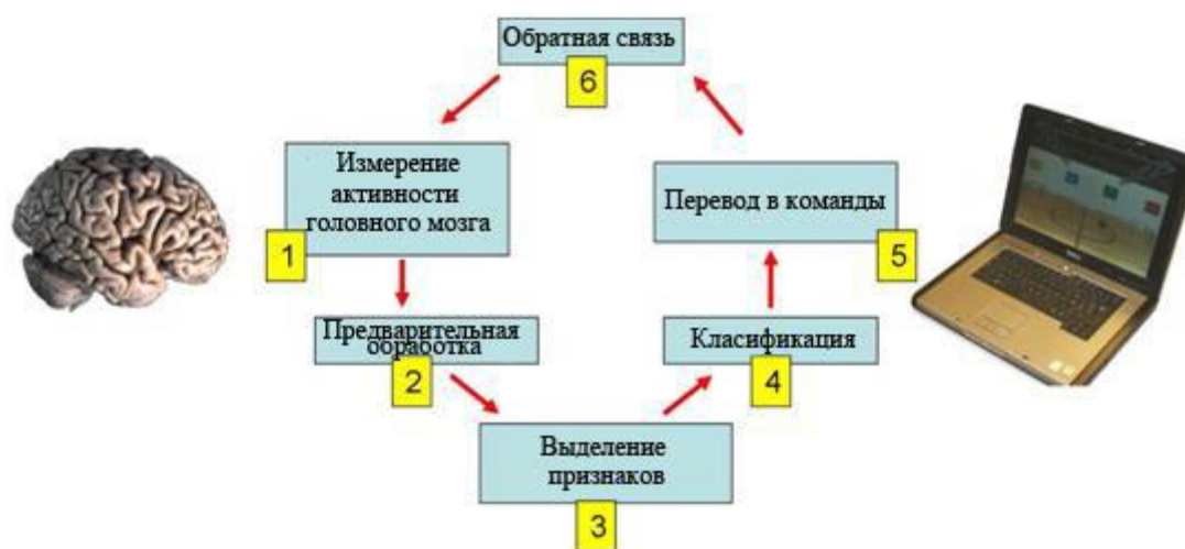
Рис. 19. Этапы обработки сигналов с помощью BCI
