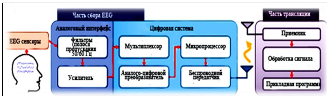
Рис. 36. Блок-схема типичной беспроводной системы BCI
