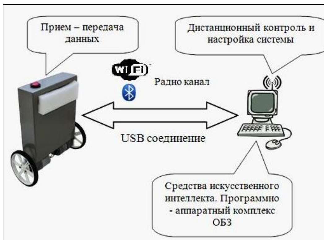
Рис. 6. Схема соединения настраиваемого устройства и ОБЗ
