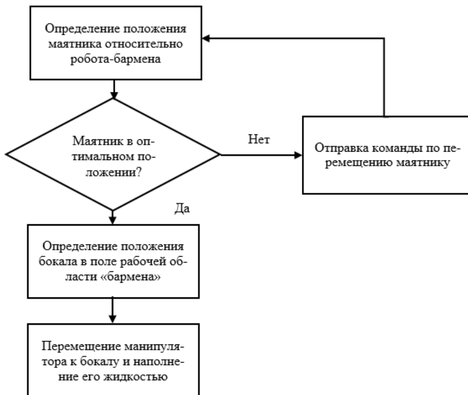
Рис. 7. Алгоритм взаимодействия перевернутого маятника и робота-бармена
