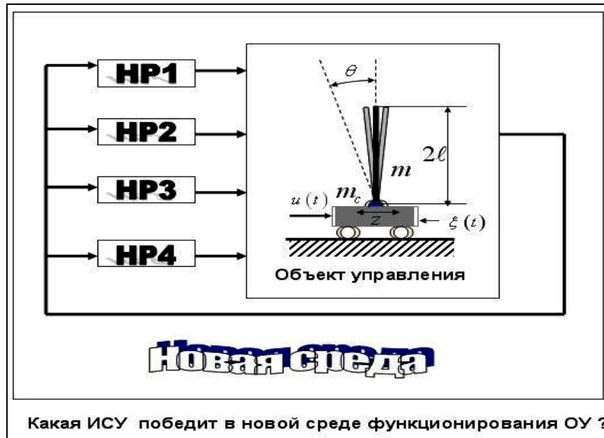
Рис. 33. Схема исследования робастности спроектированных НР
