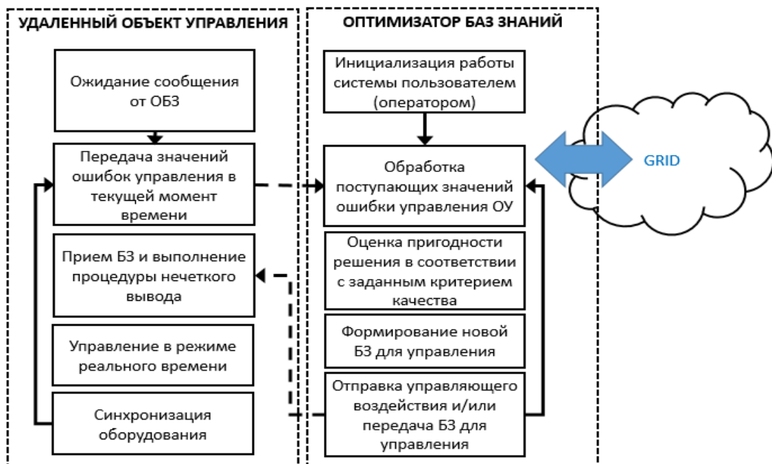
Рис. 29. Структура применения оптимизатора баз знаний в интеллектуальном управлении физической установкой на ГРИД технологии
