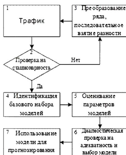
Рис. 1. Укрупненная структурная схема подбора модели ARIMA
