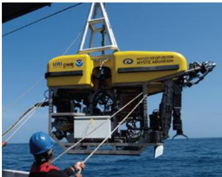
Рис. 1. Робот-манипулятор Predator (Kraft Telerobotics) на борту подводного телеуправляемого аппарата Hercules
