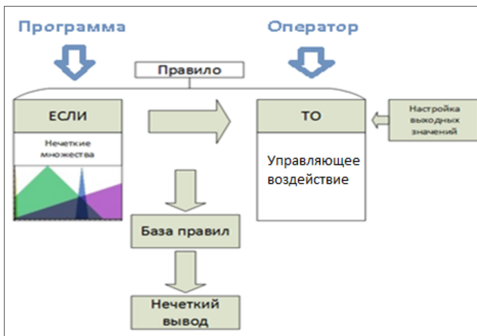
Рис. 6. Структурная схема формирования правила в базе знаний
