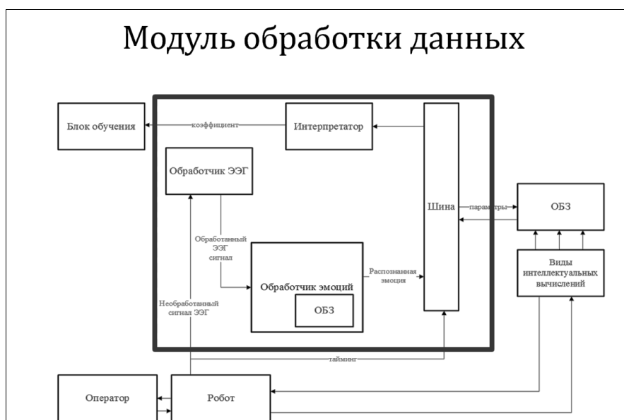
Рис. 1. Структурная схема модуля обработки данных когнитивно-интеллектуальной системы адаптации и обучения детей-аутистов
