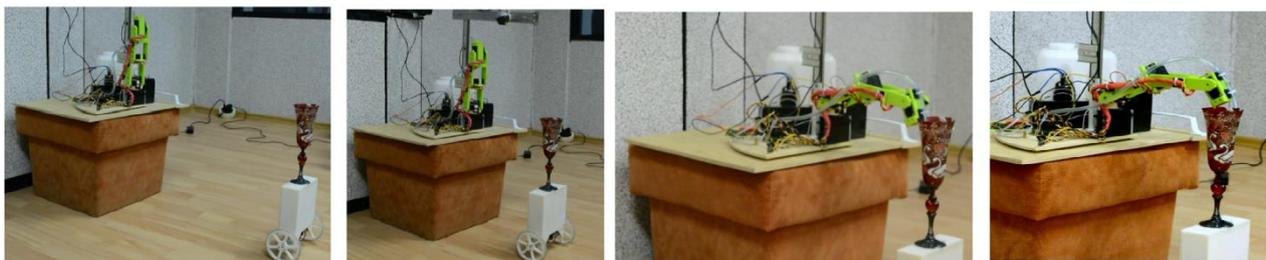
*Рис. 6. Робот-бармен наливает жидкость в бокал, установленный на перевернутом маятнике*
