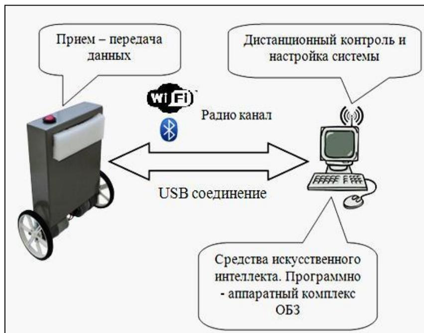
Рис. 3. Схема соединения настраиваемого устройства и ОБЗ
