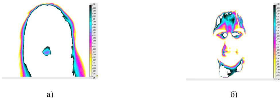
Рис. 2. Изотермы, полученные с термограмм, снятых термографом IRTIS 2000ME в разных условиях окружающей среды: а) при температуре  $-5^{\circ}\text{C}$ ; б) при температуре  $22^{\circ}\text{C}$
