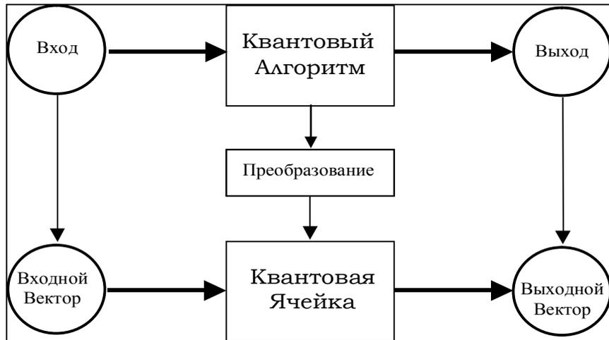
Рис. 1. Блочный подход к моделированию квантовых алгоритмов на классических компьютерах
