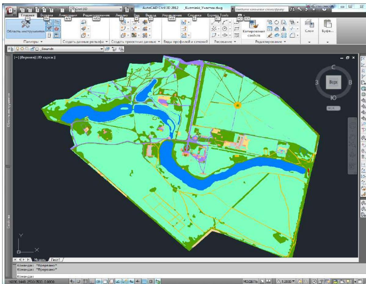
Рис. 1. Модель рельефа поверхности в Civil 3D
