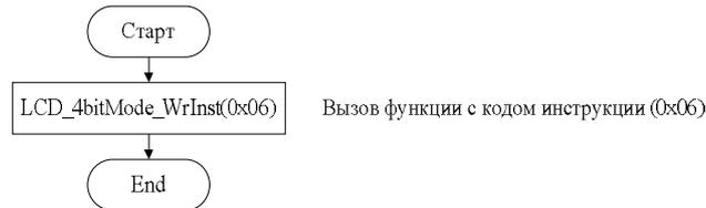
Рис. 4.9. LCD Entry\_Mode\_set (установка режима ввода)
