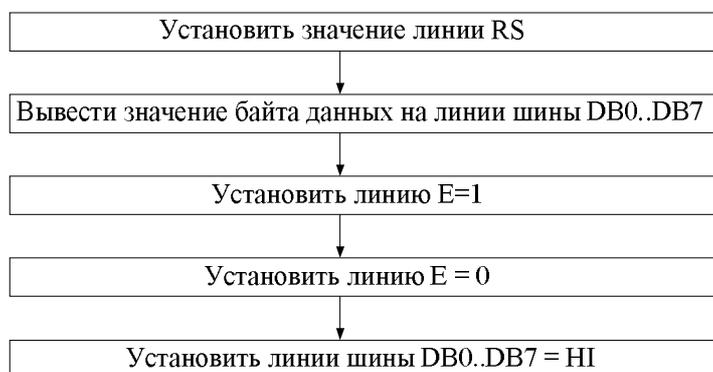
Рис. 2.6. Алгоритм записи для 8-ми разрядной шины
