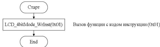
Рис. 4.8. LCD clr (очистка экрана)
