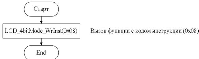
Рис. 4.7. LCD off (выключение ЖК-модуля)
