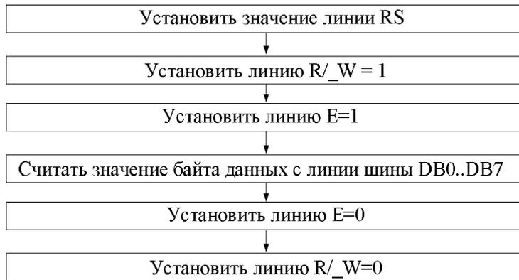
Рис. 2.7. Алгоритм чтения для 8-ми разрядной шины
