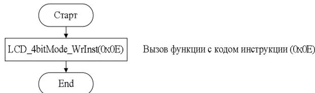
Рис. 4.6. LCD on (включение ЖК-модуля)
