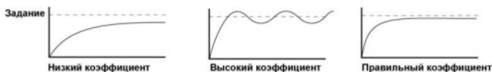
Рис. 5. Графики переходных процессов для ПИД-регулятора
