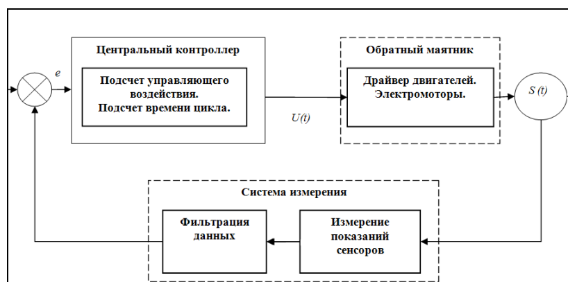
Рис. 7в. Алгоритм программы микроконтроллера
