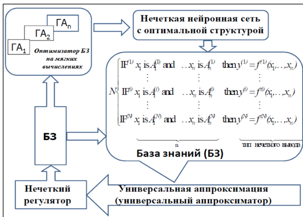
Рис. 1. Структурная схема определения параметров универсального аппроксиматора на основе ОБЗ
