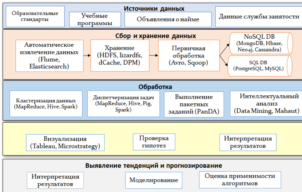
Рис. 3. Схема автоматизированной информационной системы мониторинга и анализа кадровых потребностей по номенклатуре специальностей высшего учебного заведения
