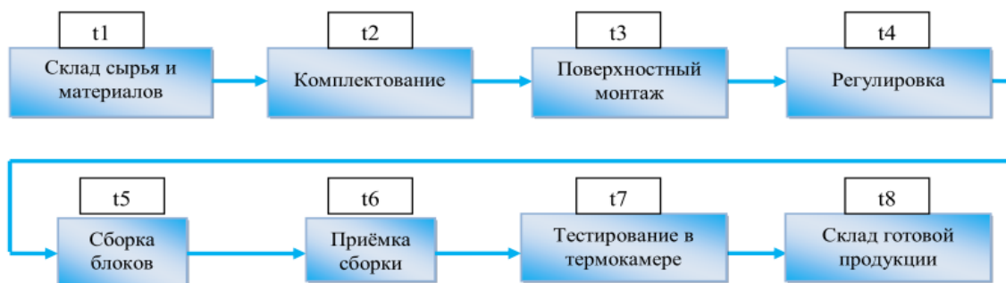
Рис. 8. Последовательность технологических операций
