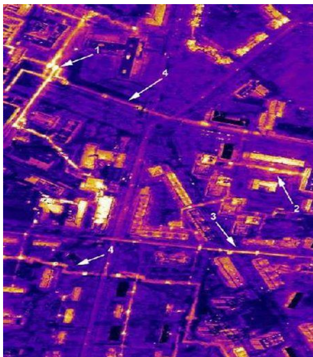
Рис. 4. Диагностика состояния подземных тепловых сетей по данным тепловой аэро-съемки (г. Королев Московской обл., декабрь 1996 г.): 1 – аварийное состояние; 2 – высокие теплотерии (аварийно-опасное состояние); 3 – повышенные теплотерии; 4 – нормированные теплотерии
