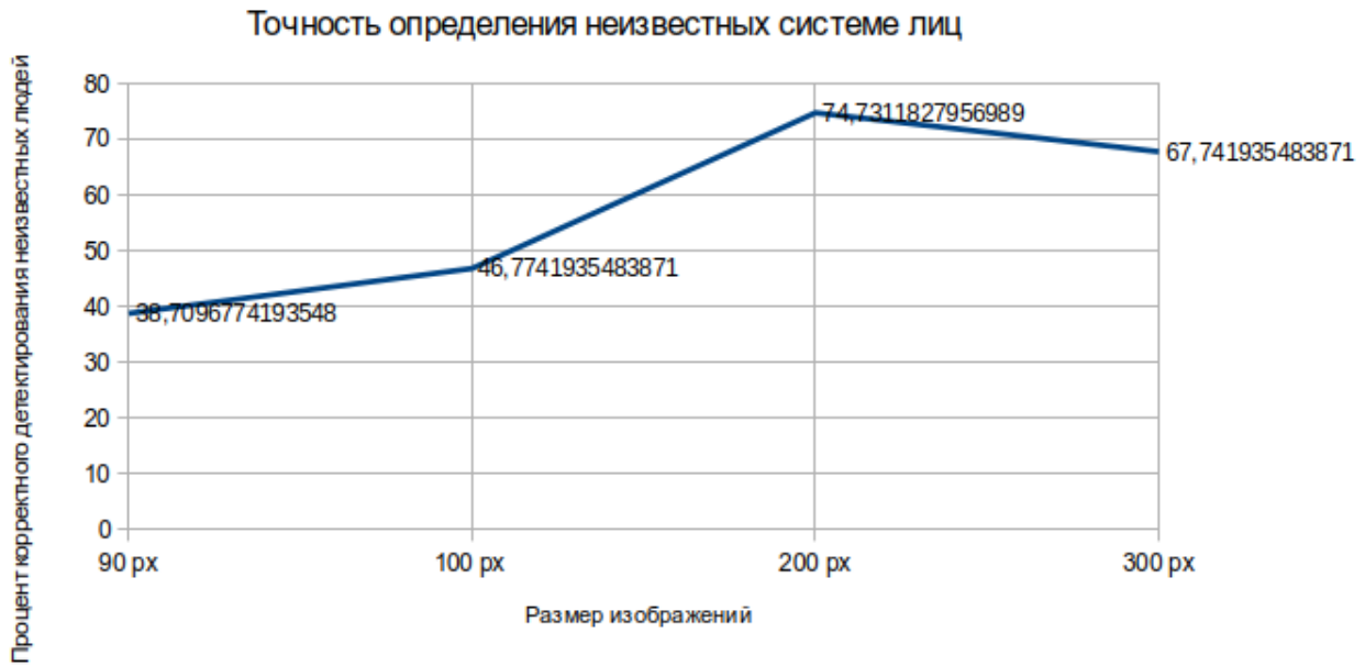
Рис. 7. График зависимости точности определения неизвестных системе лиц от размера входного изображения (на данных из папки «Unknown»)
