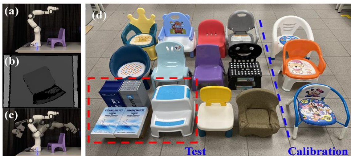
Рис. 12. Данные. (b) показывает захваченное изображение глубины, когда робот находится в позе захвата, показанной на (a). (c) показаны три позы захвата 3D-сканирования. (d) показывает все стулья в наборе данных. Среди стульев в испытательном наборе два из них, указанные в красном поле, не являются типичными стульями, но могут позволить себе сидячую возможность. Один из них - табурет; другой импровизирован, собирая книги и коробки
