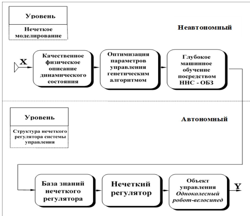
Рис. 5. Структура Нечёткого Моделирования Интеллектуальной Системы Управления
