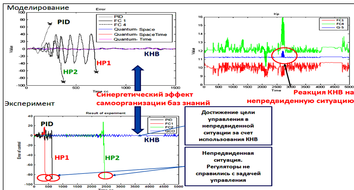
Рис. 24. Результаты моделирования и эксперимента, проведенного в непредвиденной ситуации управления для классического ПИД регулятора, нечеткого регулятора и регулятора на КНВ
