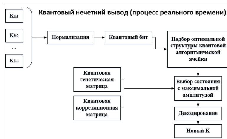
Рис. 4. Алгоритм квантового нечеткого вывода
