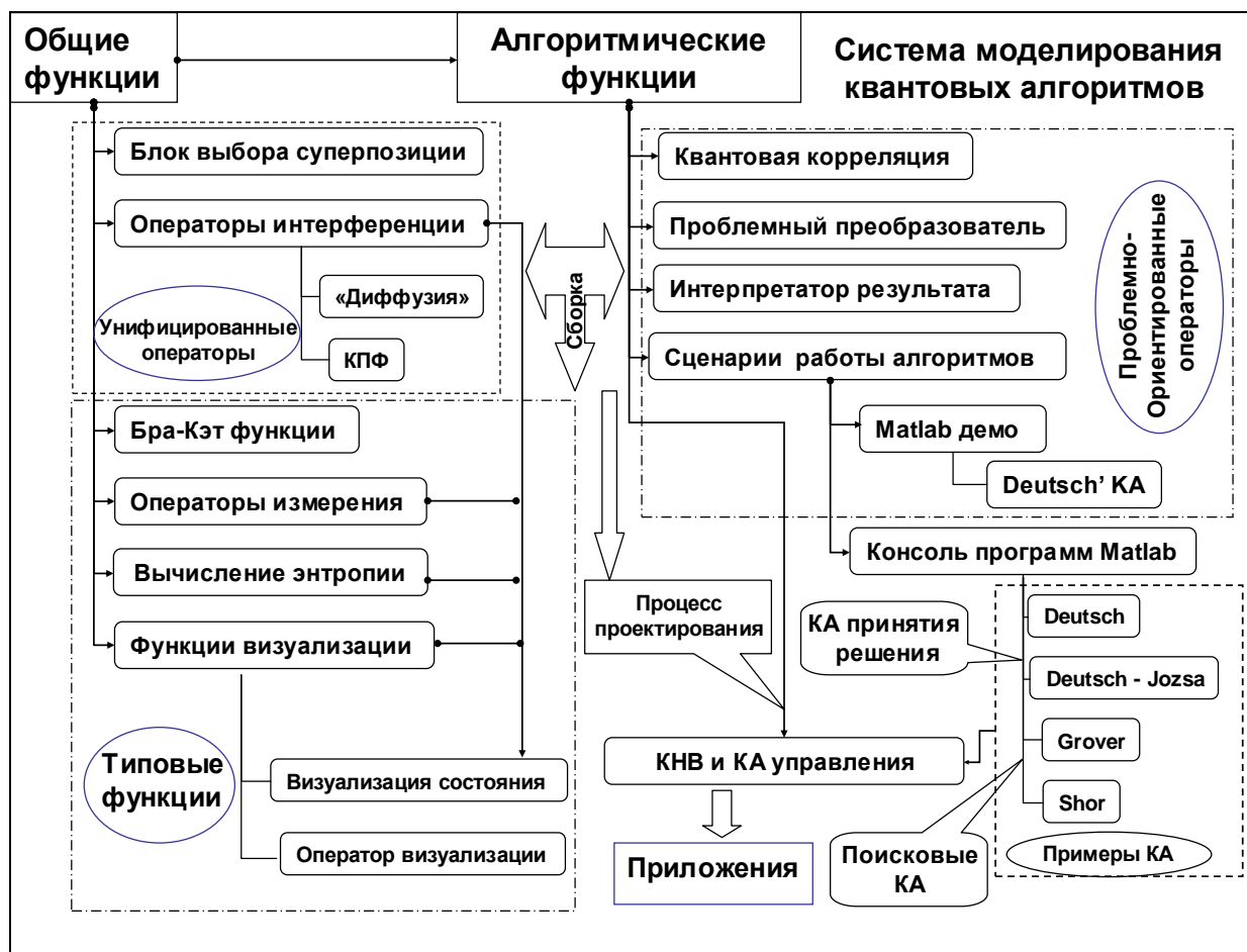
Рис. 4. Структура программного обеспечения системы моделирования КА
