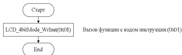
Рис. 4.8. LCD clr (очистка экрана)
