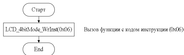
Рис. 4.9. LCD Entry_Mode_set (установка режима ввода)
