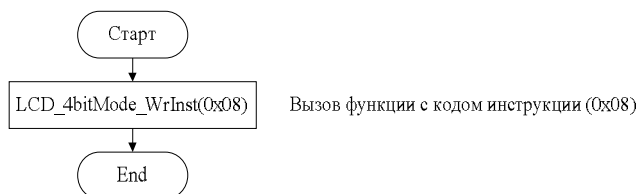
Рис. 4.7. LCD off (выключение ЖК-модуля)
